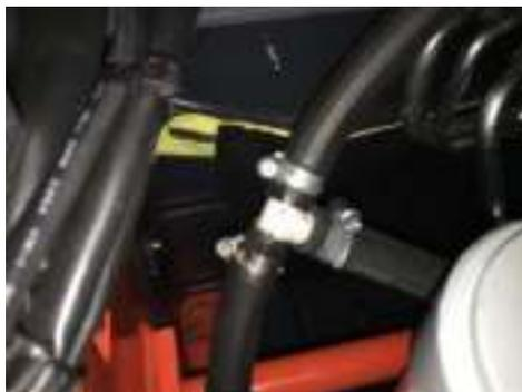
*T montada en el Tubo de retorno al tanque de de una carretilla elevadora.*
